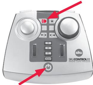
Taste drücken, gedrückt lassen und den Handsender einschalten. Wenn der Handsender eingeschaltet ist, Taste loslassen.
